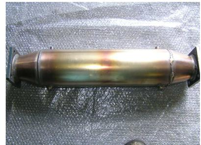
図 4. 3 - 2 酸化触媒外観
